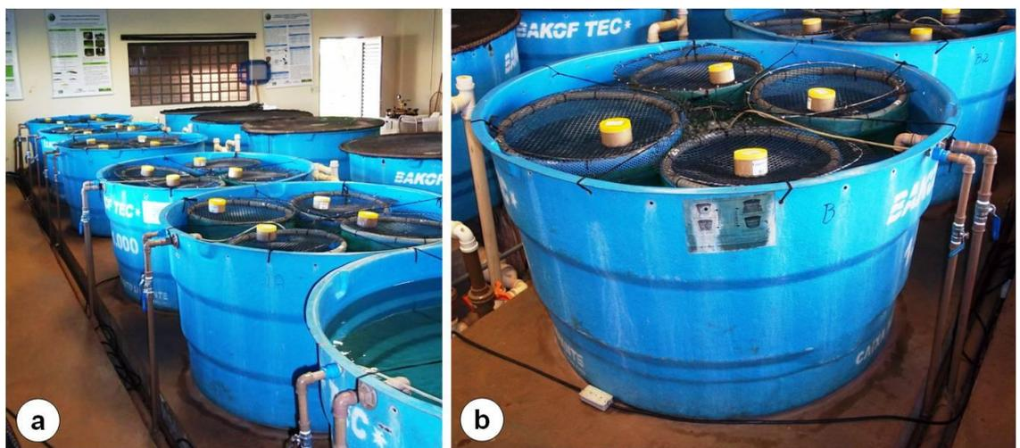
**Figura 2.** Ensaio de desempenho. Unidades experimentais totalizando 5 tanques (1000L) com 20 gaiolas (70L) (a). Destaque de um tanque onde eram posicionadas 4 gaiolas, sendo cada gaiola considerada uma repetição.
