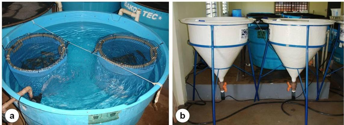
**Figura 1.** Ensaio de digestibilidade. Animais alojados em gaiolas (70L) dispostas dentro de um tanque de fibra de vidro (1000L), com circulação contínua de água (a). Aquários de coleta de fezes (190L), com sistema de aeração por meio de pedra porosa acoplada a um aerador central, onde os peixes permaneciam até a manhã seguinte (b).
