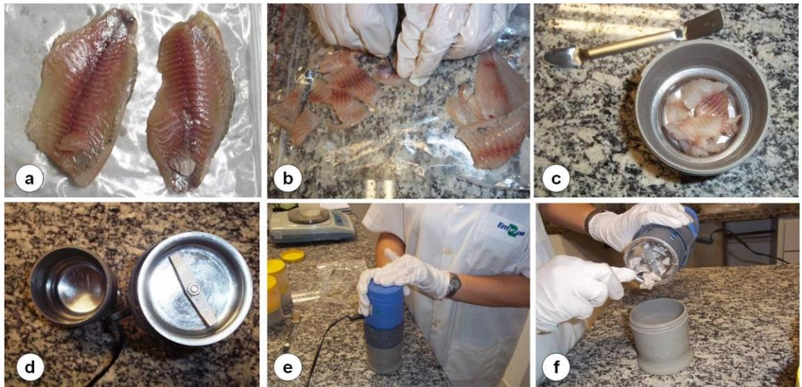
**Figura 7.** Processamento dos filés para análise da composição centesimal. Filés inteiros (a), cortados (b) e dentro do recipiente pronto para triturar (c). Micro-moinho manual (d), trituração da amostra (e) e retirada para secagem e posterior análise (f).
